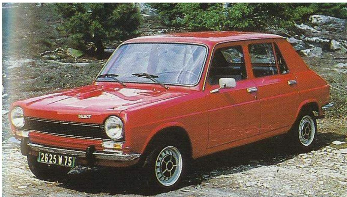
*Simca 1100 Spéciale - 7 CV - 155 km/h. Cylindrée 1 294 cm<sup>3</sup>, 75 CV à 5 800 t/m.*
