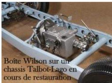
Fonctionne aussi avec des trains d'engrenages épicycloïdaux, il y a 4 vitesses et une marche arrière, la 4<sup>e</sup> étant en prise directe. Sa caractéristique innovante est la présélection des vitesses : choix préalable d'une vitesse, et passage de cette vitesse par action sur la pédale d'embrayage.
