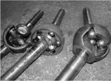
Invention de Pierre Fenaille et Jean-Albert Grégoire dit joint « Tracta » (*brevet de décembre 1926*) permettant une transmission sans à-coups aux roues avant motrices et directrices (*Amélioration du joint de cardan*). Utilisé sur toutes les Tractions Avant à partir de 1927, en particulier sur les Jeeps de l'armée américaine. Le joint tripode improprement appelé double Cardan, et le joint Rzeppa breveté aussi en 1926, utilisent le même principe de fonctionnement.
