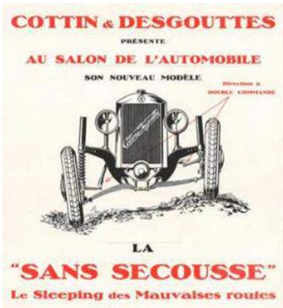
Elle produit aussi des moteurs d'avions Gnome-et-Rhône. En 1925, C. D. présente la « Sans-Secousse » voiture révolutionnaire pour l'époque avec 4 roues indépendantes et amortisseurs à palettes Houdaille. En 1930, le Rallye Alger-Le-Cap est gagné par 4 Sans-Secousse.
