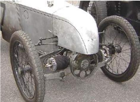
Avec le moteur placé devant l'essieu avant, le cyclecar Sima-Violet n'est pas à traction avant. Cet engin aurait été fabriqué à 5 000 exemplaires y compris ceux construits par Alcyon. Une voiture de course à moteur 4 cylindres, surbaissée fut présentée en 1927.
